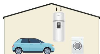
Garagem ou lavanderia (sem conduta)
