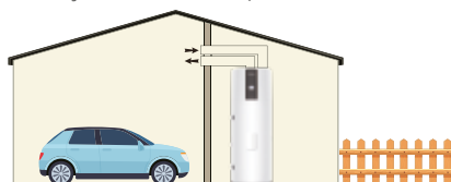
Instalação com 2 condutas numa divisão não aquecida >15m²
